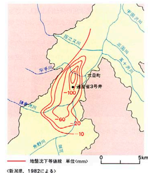
図1・9 - 新潟県六日町の地盤沈下(1975~1981)
